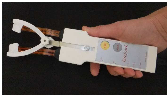
Abb. 1: Handstück des biteForce Systems ( Vi.me.S., Igel, Deutschland)
